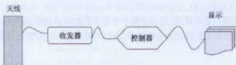
图 T 0913 雷达系统组成图
